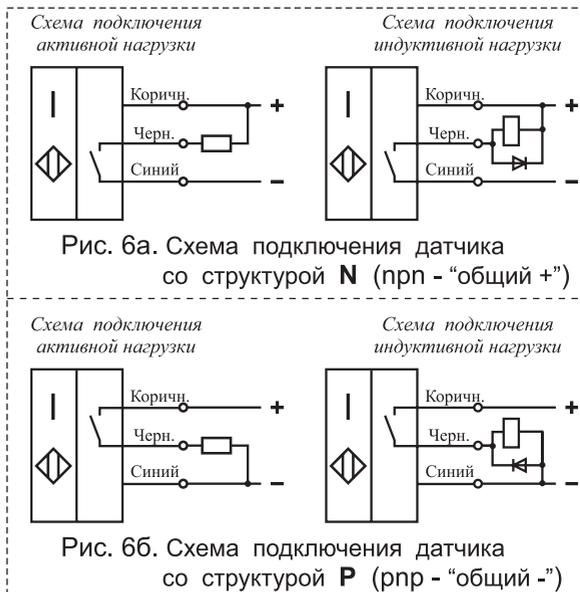
Рис. 6а. Схема подключения датчика со структурой **N** (nрп - "общий +")
