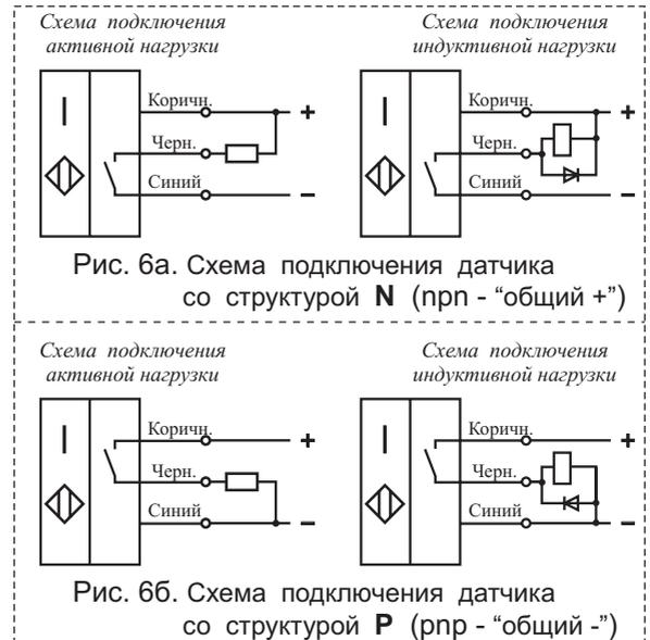
Рис. 6а. Схема подключения датчика со структурой N (rpr - "общий +")
