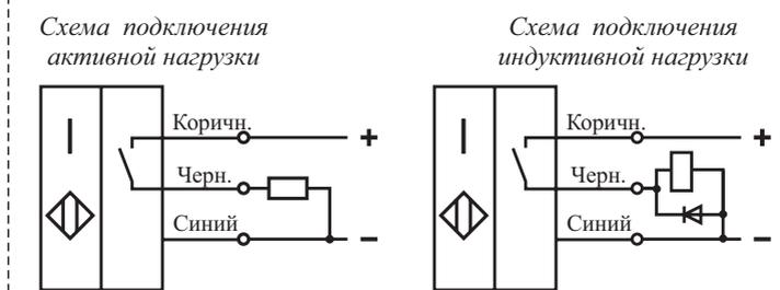
Рис. 8б. Схема подключения датчика со структурой P (npr - "общий -")
