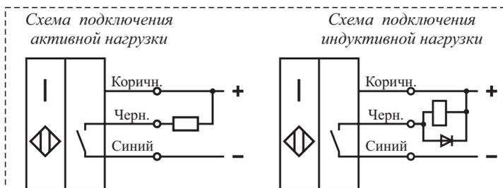
Рис. 8а. Схема подключения датчика со структурой N (npr - "общий +")
