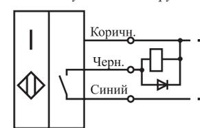
Схема подключения активной нагрузки
