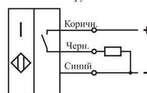
Схема подключения индуктивной нагрузки
