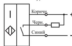
Рис. 6а. Схема подключения датчика со структурой N (npp - "общий +")
