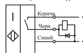
Рис. 6б. Схема подключения датчика со структурой P (ppp - "общий -")
