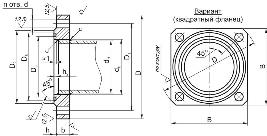
Рис. 3. Фланцы по ГОСТ 33259-2015 (исполнение уплотнительных поверхностей - D)
