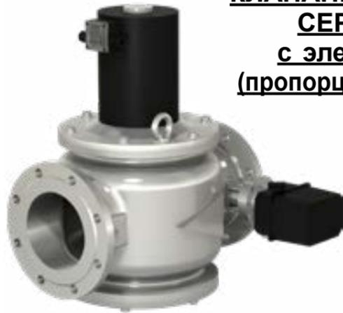
В конструкцию клапана встроен регулятор расхода, при помощи которого осуществляется изменение количества пропускаемого газа через клапан. Конструктивно регулятор расхода находится по ходу газа перед основным затвором.
